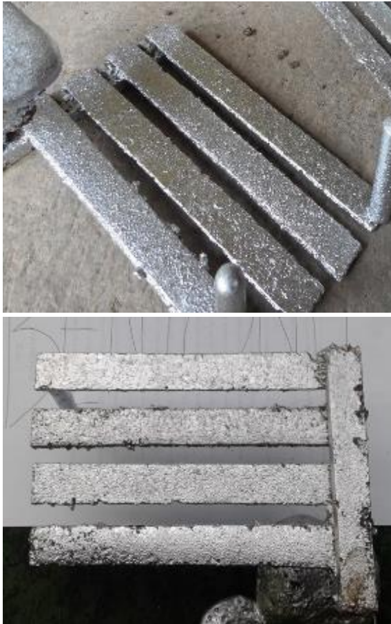
Gambar 1. Hasil Coran dengan Pengikat Bentonit 15%
