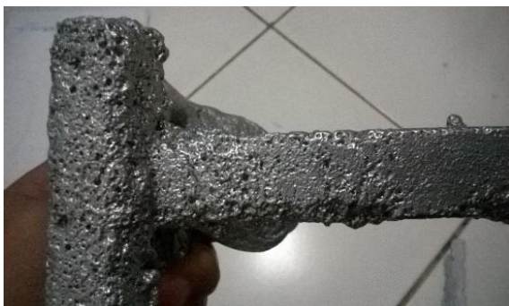
Gambar 2. Cacat pada Benda Cor
