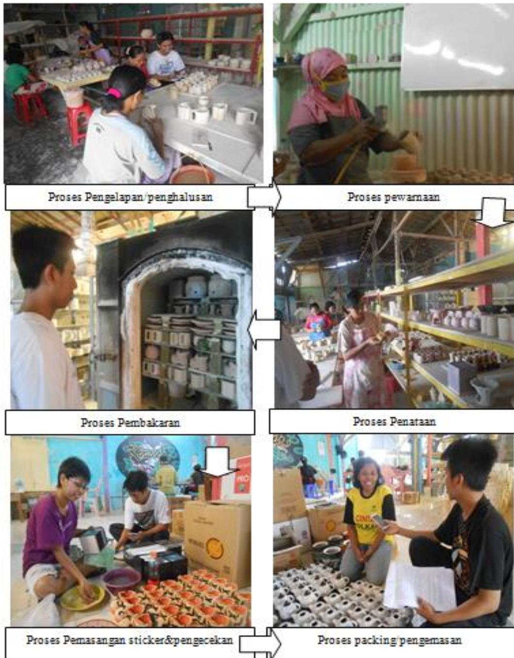
**Gambar 5. Proses Pembuatan Keramik**
