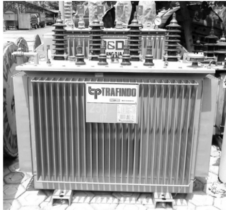
Gambar 1. Konstruksi transformator 3 fase merk Trafindo.
