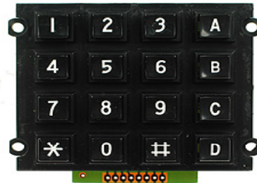
Gambar 2 Bentuk dari Keypad 4x4 (Sumber : Crameda Intersys,2008)
