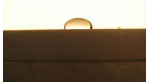
Gambar 3. Sudut kontak specimen S8A2 pada penyinaran UV 24 jam
