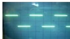
Gambar 17 Bentuk sinyal keluaran Demodulator FSK
