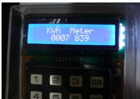
Gambar 19. Kwh meter pada LCD
