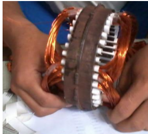
Gambar 6. Pemasangan Belitan Pada Slot Stator
