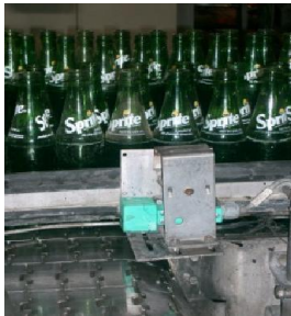
Gambar 2. Proximity Switch Untuk Mendeteksi Akumulasi Botol Sumber : (Riyadi : 2011)
