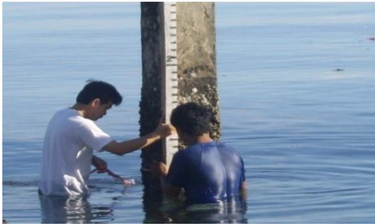
**Gambar 5. Pengukuran Tinggi Pasang Surut**
